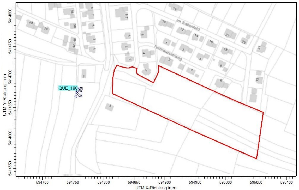
Abbildung 8. Lage der modellierten Emissionsquellen – Detailauszug Plangebiet, Volumenquellen (dunkelblau schraffiert, blaue Beschriftung), Plangebiet rot umrandet. Hintergrundkarten: Geobasisdaten © LGL, LUBW [31].
